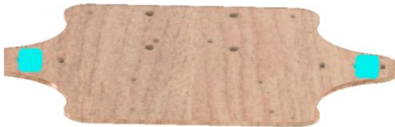
圖 4.4-9 頂板約束配置圖
