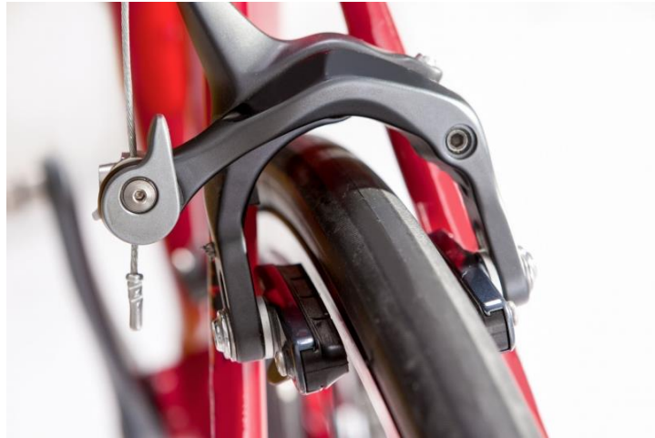
圖 3.3-3、夾住車輪的設計靈感源自於腳踏車煞車[9]
