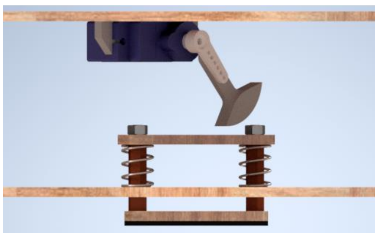
圖 3.3-6、煞車系統配置
